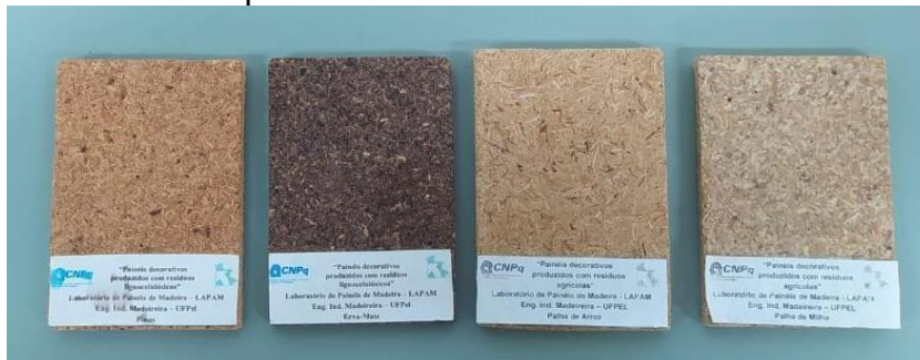
Figura 1. Painéis aglomerados de madeira de Pinus sp e resíduos lignocelulósicos: erva-mate, palha de arroz e palha de milho.
