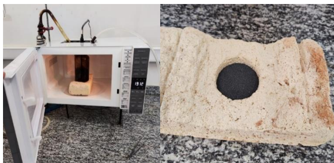
Figura 2. Reator de pirólise instalado em base refratária contendo SiC.
