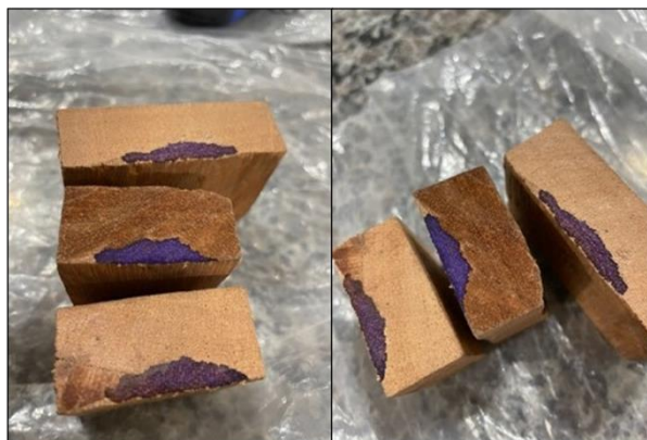
Figura 1. Aplicação do teste com Cromoazurol S em madeiras da família Vochysiaceae.
