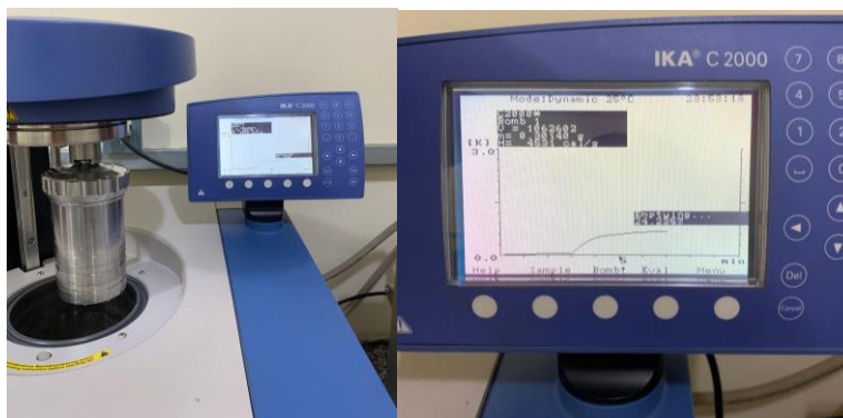
Figura 1. Determinação do Poder Calorífico Superior na bomba calorimétrica adiabática.
