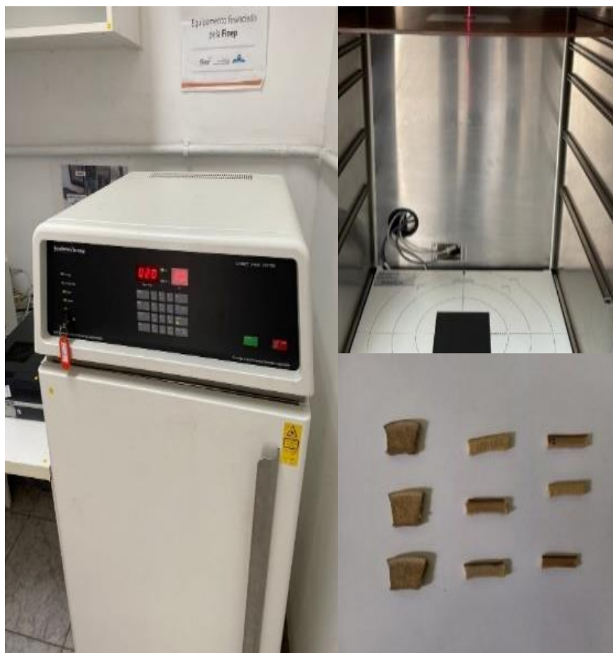
Figura 1: Amostras de D. asper , confeccionadas com 2 mm de espessura (B) e o equipamento de raios X utilizado (A), modelo Faxitron LX-60.
