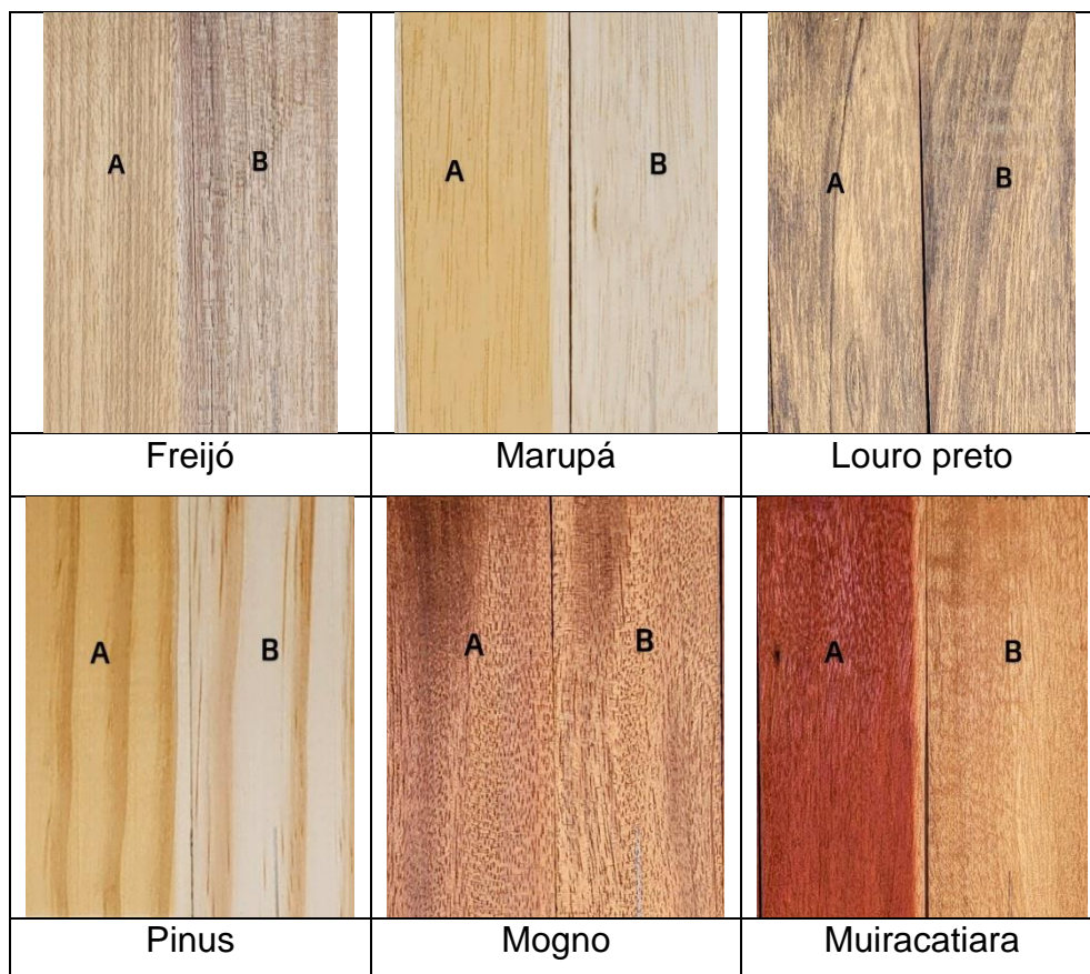
Figura 1. A imagem apresenta as espécies de Freijó, Marupá, Louro preto, Pinus, Mogno Africano e Muiracatiara, antes (B) e após (A) aplicação de UV.
