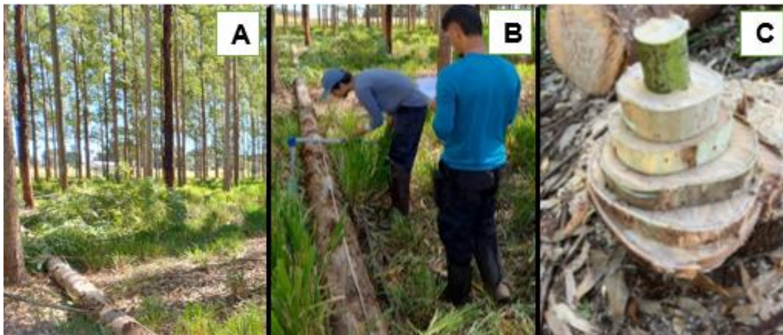
Figura 1. Área experimental dos clones de Eucalyptus spp. em sistema integrado de produção (A); árvore cortada e marcação das posições longitudinais no tronco (B) e discos de madeira cortados por posição longitudinal da base ao topo (C).
