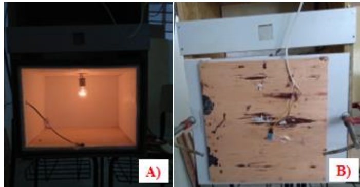
Figura 4. Realização da análise térmica, onde A) Câmara térmica e B) Execução do teste.
