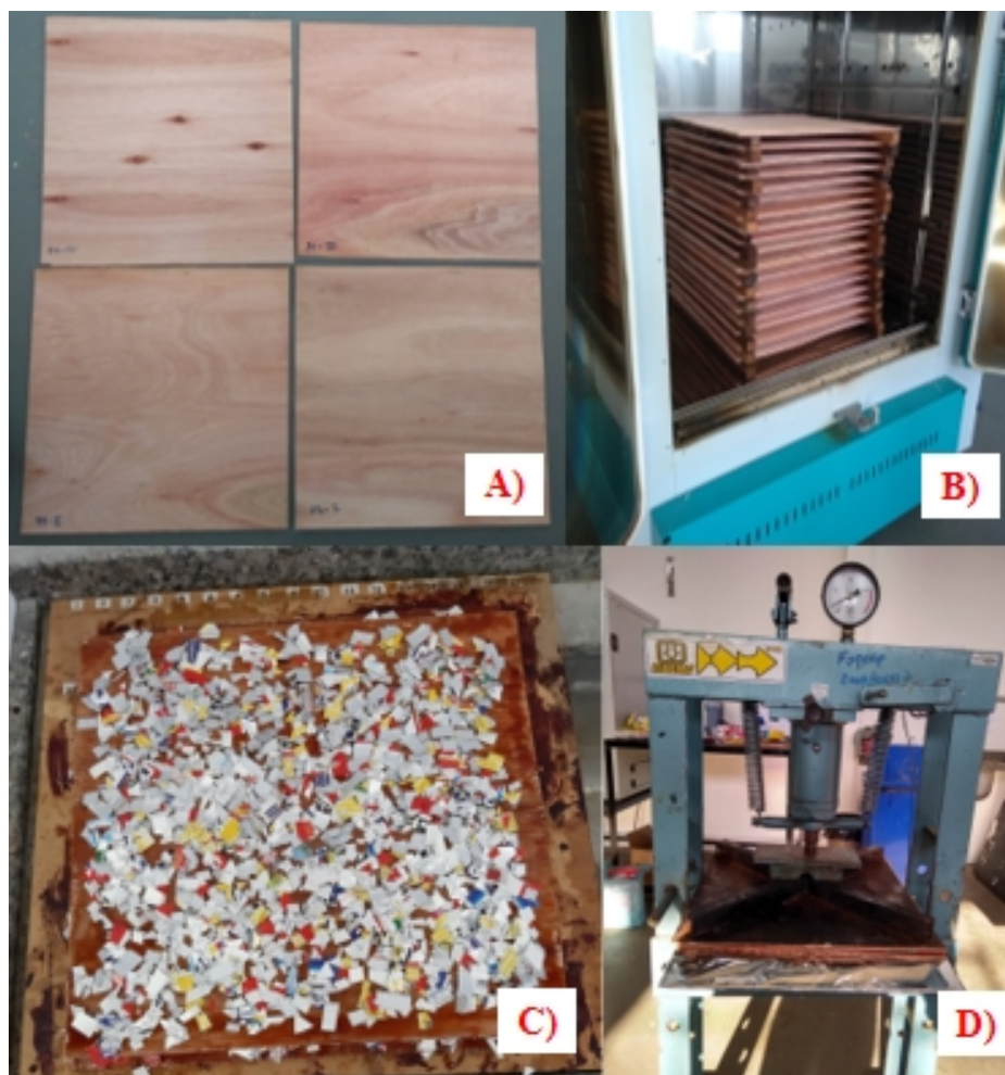
Figura 2. Estágios de produção dos painéis, onde A) Classificação visual, B) Secagem das lâminas, C) Formação do painel, e D) Pré-prensagem.
